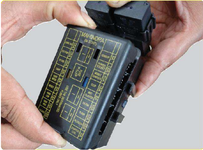
1. Presione la cubierta de los fusibles de la parte superior e inferior para quitarla.
