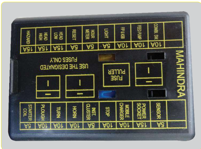
5. Mantenga la llave de encendido en su lugar y saque el fusible de reinicio. Espere al menos 10 segundos.
