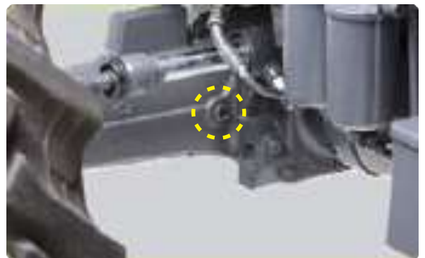
Grado del aceite - SAE 80 W90 GL5 Llenado de aceite en eje 4WD.
