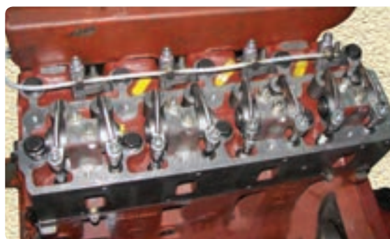
Verificación de la holgura de las válvulas
